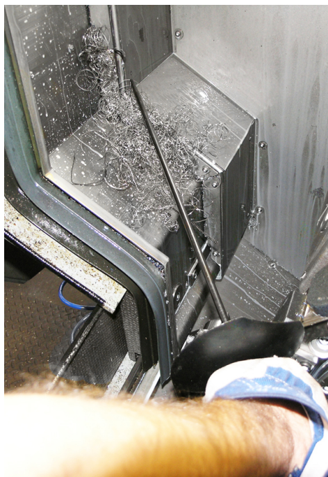
Exemple : 1 Éliminer les amas de copeaux à l'aide d'un outil approprié (par ex. crochet à copeaux)
