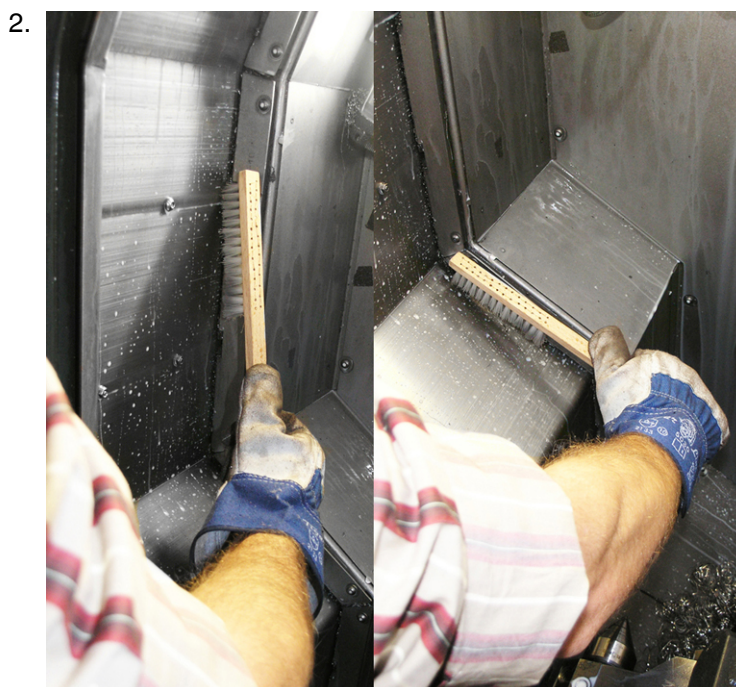
Exemple : 2 Balayer les petits copeaux et les autres saletés à l'aide d'un balai ou d'une brosse à copeaux, en partant du haut vers le bas.
